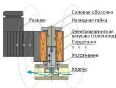
Рисунок 9 – Электромагнитный исполнительный механизм
